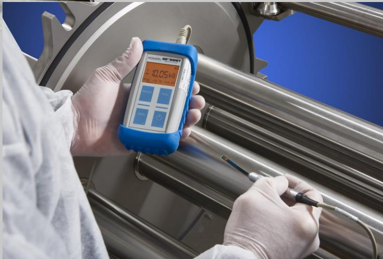
Ein Flussdichtemesser (oben links) und seine Anwendung auf ein magnetisches Trennsystem (unten rechts)
