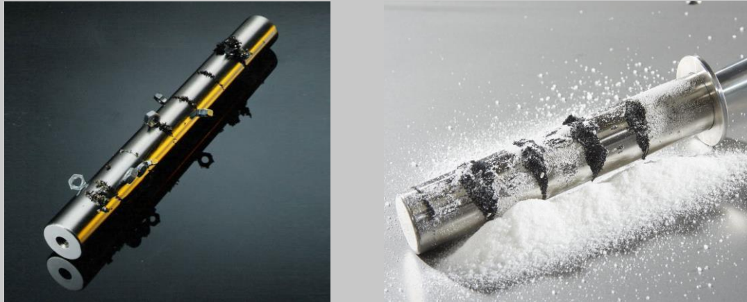
Magnetstäbe, die in Magnetseparatoren verwendet werden. Partikel, die erfasst werden, sammeln sich auf dem Stab in der Nähe der Polplatten, da der Force Index dort am höchsten ist.
