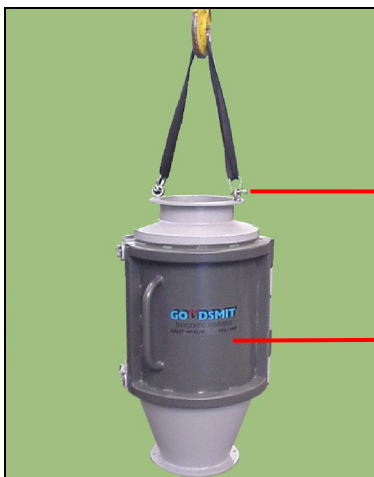
Foto: Heben vom Rohrmagnet
