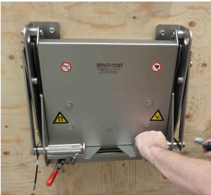
Sobald der Rinnenmagnet an der Produktrinne angebracht ist, entfernen Sie die Kabelbinder.
