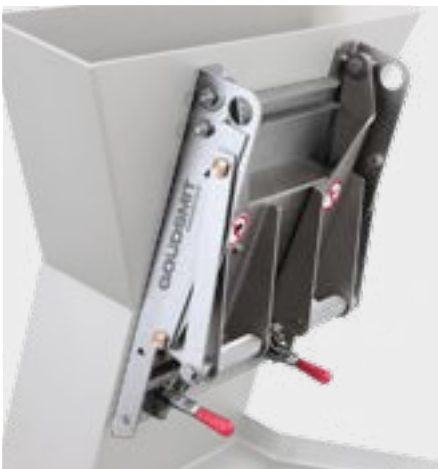
Rutschmagnet in Zuckerproduktion für den Produkteinlaß
