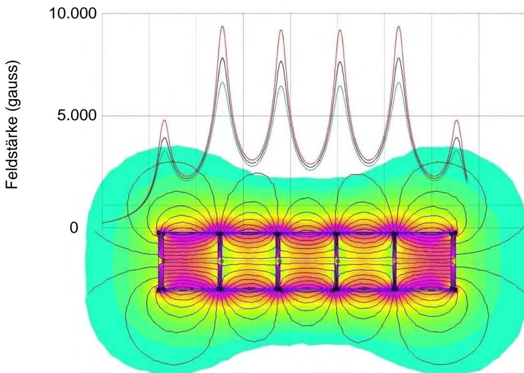
Beispiel: Magnetstab Ø23 mm (GSN-42) im Extraktorrohr Ø25 mm
