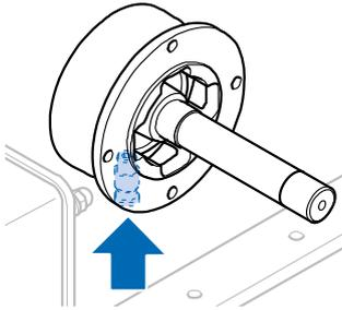
Il y a une connexion d'air entre le motoréducteur et le caisson de l'appareil pour créer une surpression. Le rinçage à l'air empêche les produits de sortir. D'autre part, il empêche la saleté provenant de l'extérieur de pénétrer dans le canal du produit. Si une prise d'air comprimé est raccordée à la bride de montage du moteur, la pression de la prise d'air ne doit pas dépasser 0,05 bar.
